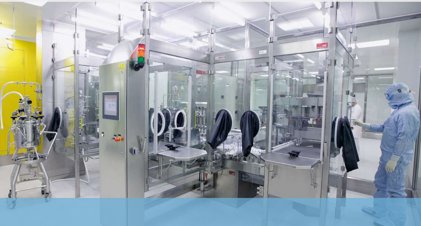
Vial Füll- und Verschließmaschine FLC 3060 mit RABS bei hameln pharma
