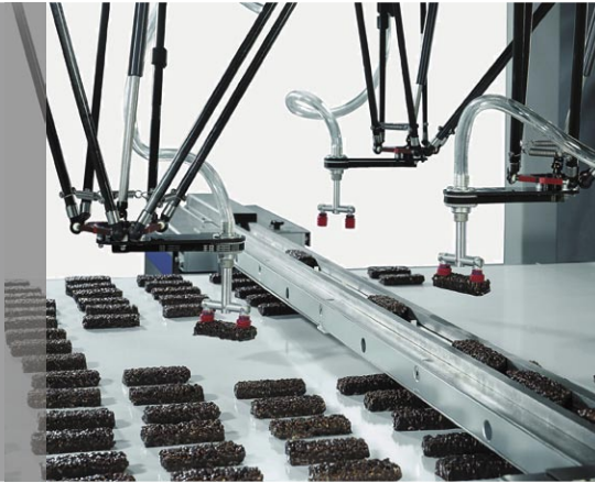
Delfi Feed Placer ausgerüstet mit 3 Robotereinheiten befüllt die Zuführkette einer Schlauchpackmaschine
