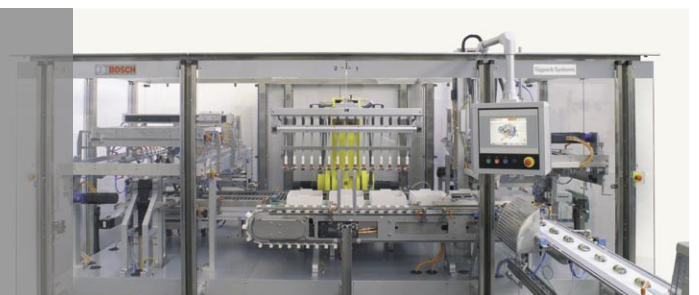
Integrierter Toploader TTLi mit Schachtelaufrichter und -verschlusser
