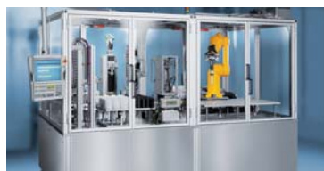
Fig. 3: HTF-System with Stäubli handling robot
